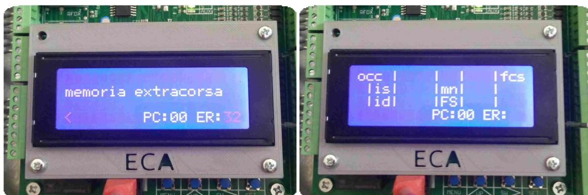
Per riattivare l'impianto, dopo aver riportato la cabina nella situazione con extracorsa chiuso, resettare l'errore usando il comando di [reset extracorsa](#) che si trova nella voce [manvora](#) del [menu](#).
