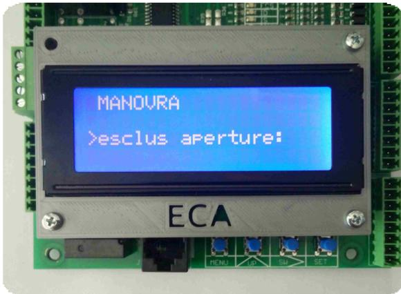
Esclusione apertura delle porte. Può risultare utile usare questo comando nel caso in cui si vuole fare delle prove ed impedire l'accesso in cabina agli utenti.
