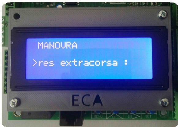
Resetta l'errore di extracorsa in **impianti oleodinamici**.
